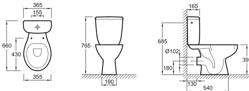
Спецификация продукта: Унитаз-компакт с горизонтальным выпуском. E0383N. Коллекция: BRIVE. РАЗМЕРЫ (СМ): 66 x 35,50 см. ВЕС: 28 кг. ТИП УСТАНОВКИ: Напольные. РАСХОД ВОДЫ: Стандарт: 3/6 л. ВЫСОТА: Комфорт. ОБОД: Стандарт. ПРОДУКТ В КОМПЛЕКТЕ: (бачок в комплекте). КРЫШКА-СИДЕНЬЕ: Не входит в комплект. ГАРАНТИЯ НА КЕРАМИКУ: 25 лет. УПАКОВКА: Единая упаковка.
